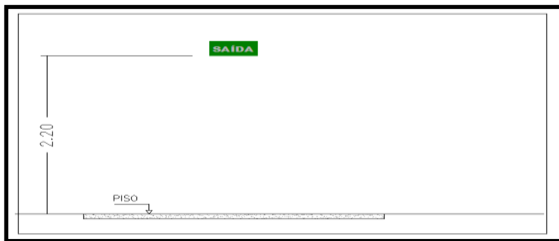
Figura 12 - Instalação da Placa de Sinalização
